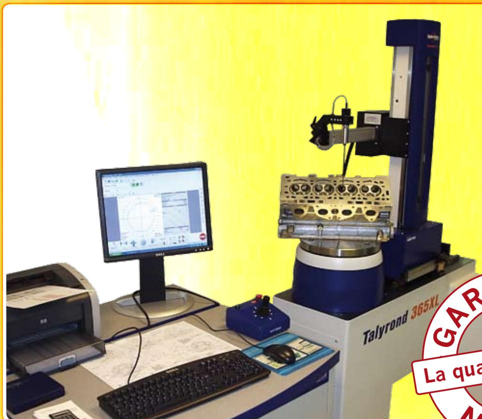
**NEWEN®** s'est doté d'une machine de contrôle **TALYROND 365XL**, spécialement conçue et dédiée à la mesure des formes, coaxialités, états de surface...
